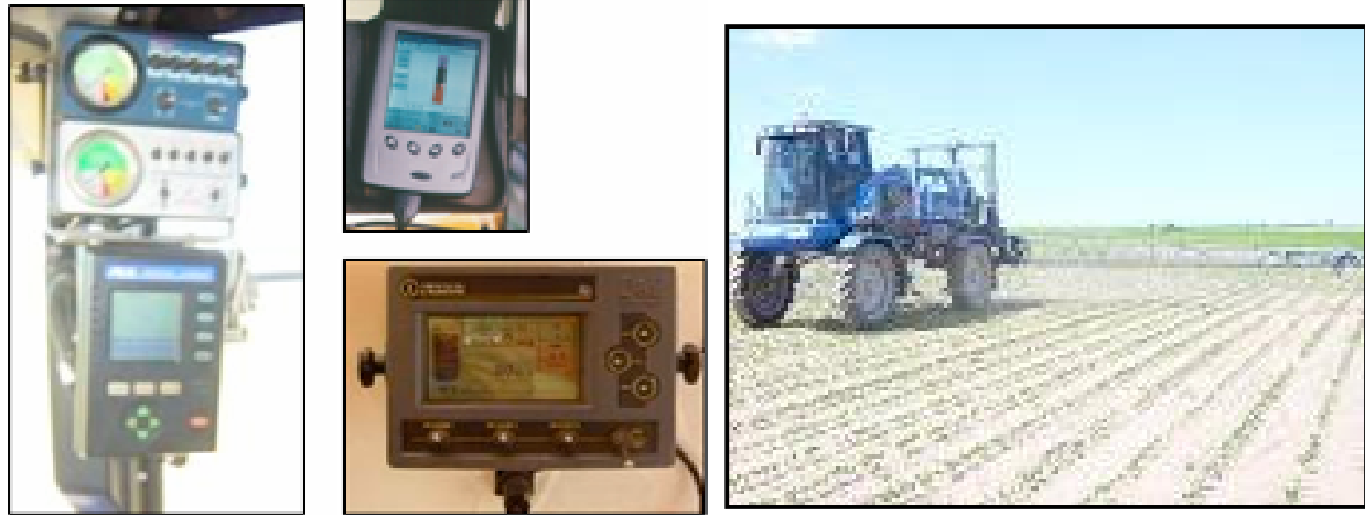
Fig. 9: Equipamiento disponible en pulverizadoras para realizar dosis variable de fertilizantes líquidos chorreados en tiempo real por medio de una recomendación más GPS o en forma manual. En tiempo real más recomendación la opción podría ser una palm top con software de dosis variable o monitores específicos que son navegadores. Pulverizadora equipada para pulverizar y fertilizar al mismo tiempo (2 tanques, 2 botalones v 2 computadoras).
